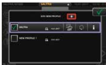
Profils pour les opérateurs et les outils qui peuvent être facilement modifiés à partir de n'importe quel menu d'écran. Tous les changements de réglages sont sauvegardés dans le profil sélectionné.
